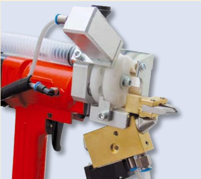
Système d'encollage fermé haute pression de 6 bars par buse
